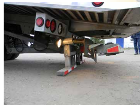
Для предотвращения эффекта «качелей» при загрузке ТС на платформу, в ее задней части предусмотрены самоустанавливающиеся опоры
