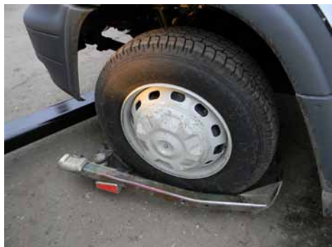
Подъехав к колесам передней или задней оси «жертвы» в упор, оператор фиксирует колеса специальными стальными скобами. После фиксации колес тросами, балка приподнимает эвакуируемое ТС за ось и автопоезд готов к транспортировке
