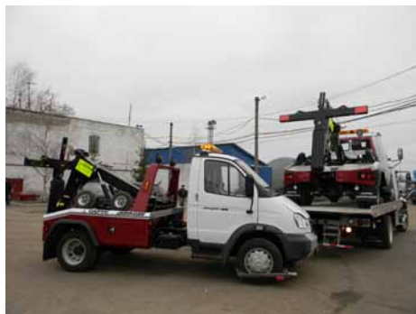
Подъехав к колесам передней или задней оси «жертвы» в упор, оператор фиксирует колеса специальными стальными скобами. После фиксации колес тросами, балка приподнимает эвакуируемое ТС за ось и автопоезд готов к транспортировке
