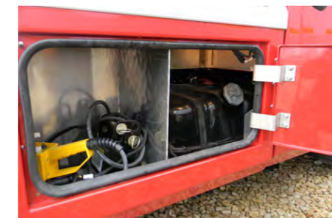
Посмотрите, насколько удобно расположена заливная горловина у эвакуатора от «Сарус» (справа) и как неудобно будет заправляться на машине конкурента
