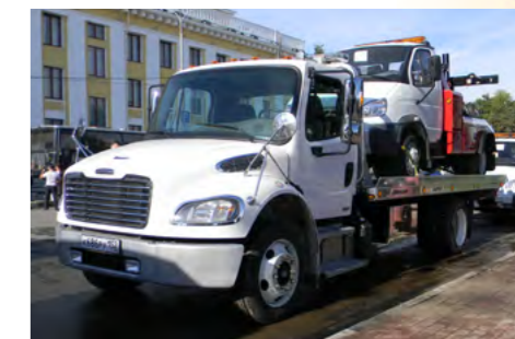
Демонстрационный эвакуатор со сдвижной платформой Jerr-Dan на базе американского Freightliner, российские клиенты заказывают на базе КАМАЗа и МАЗа
