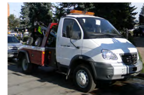
Наиболее востребованный у российских потребителей эвакуатор-полупогруз Jerr-Dan MPL-40 на укороченном шасси ГАЗ-33108 «Валдай»
