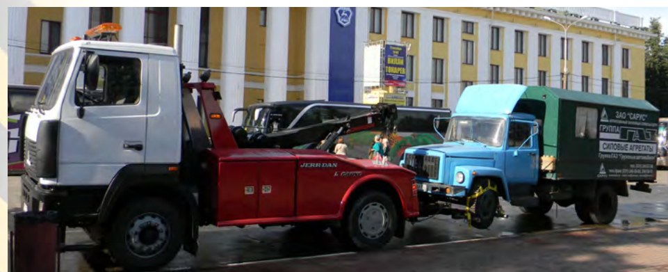
Самый компактный в тяжелом классе 16-тонный полупогруз Jerr-Dan на шасси седельного тягача МАЗ-5440, который уверенно эвакуирует не загруженные автопоезда
